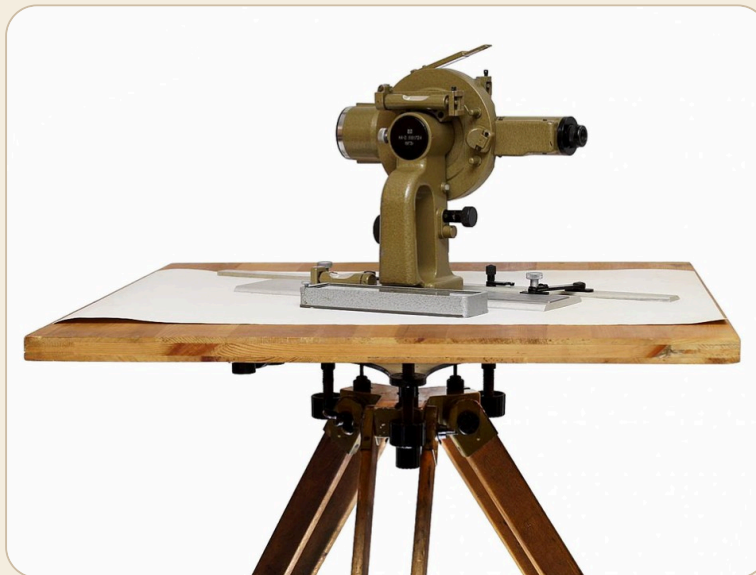
KA-2 automatic alidade (1973) on a plane table · Source
