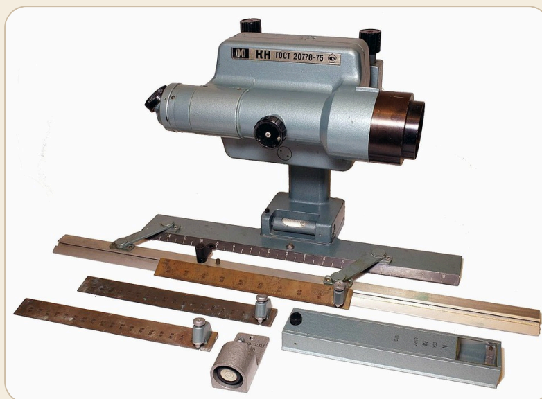
KN nomographic alidade (1986) · Source
