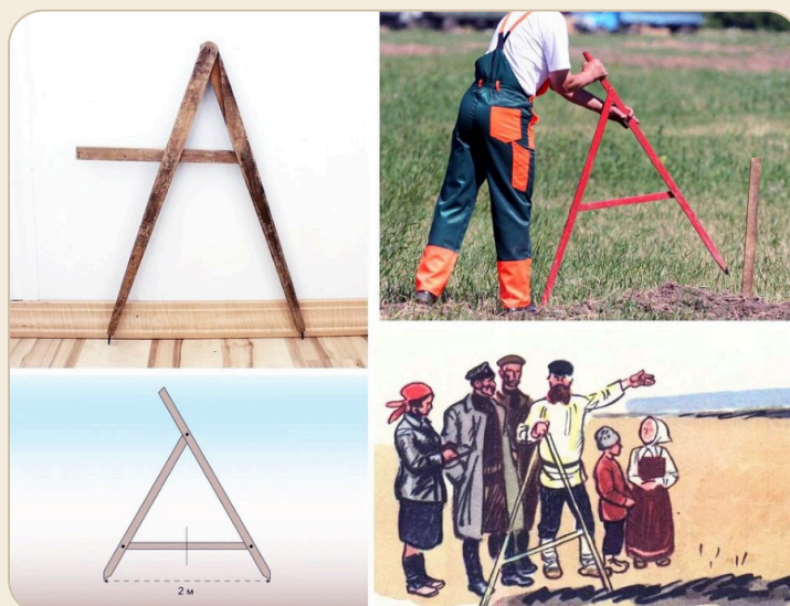
Внешний вид и способ применения полевого циркуля · Источник
