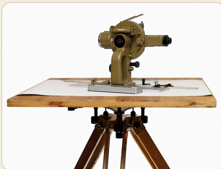
Кипрегель-автомат КА-2 (1973) на мензульном столике · Источник
