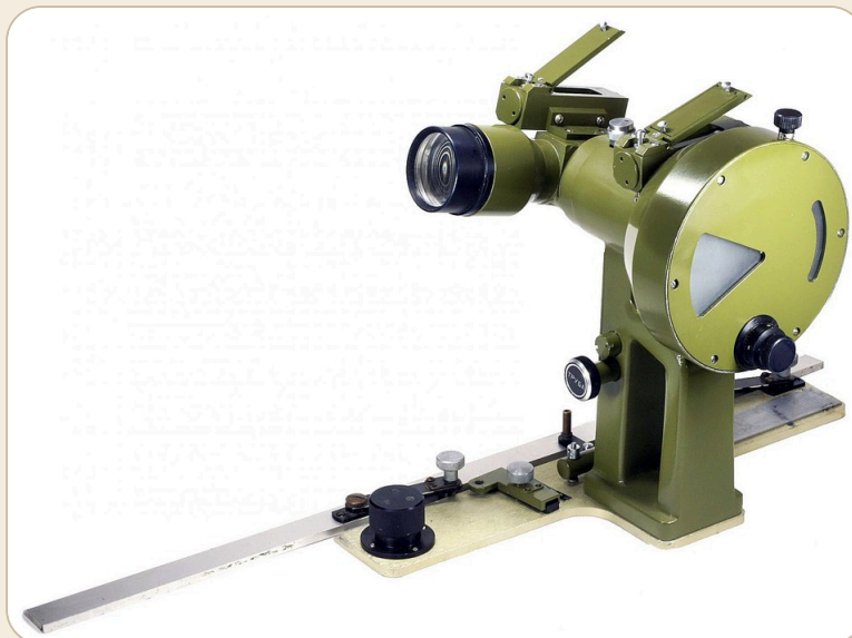
Кипрегель-высотомер Ширяева КВШ-8 (1970) · Источник
