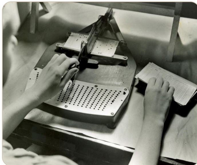
Пантографический перфоратор, использовавшийся для создания перфокарт в системе Холлерита · Источник
