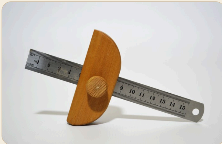
Рейсшина с двухпланочной головкой · Источник
