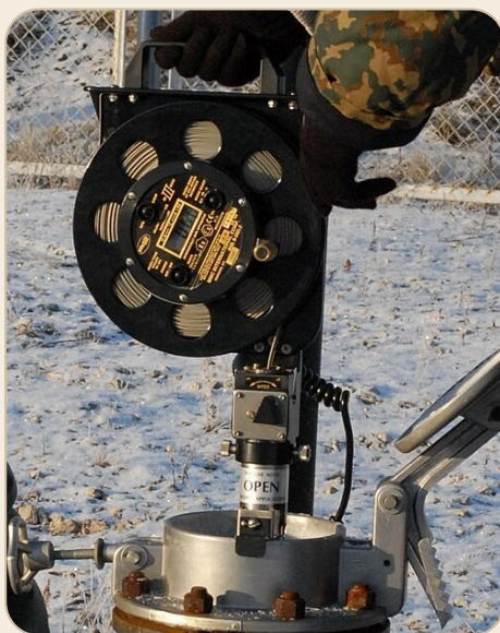
Электронная рулетка для измерения уровня нефти в резервуарах · Источник
