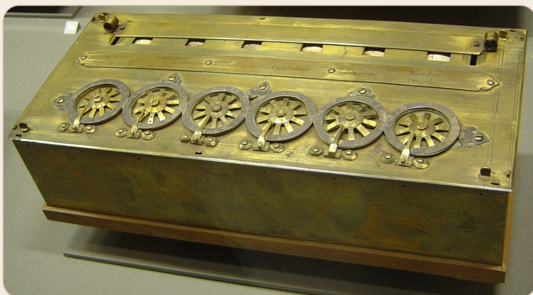
Суммирующая машина «Паскалина», 1642 · Источник
