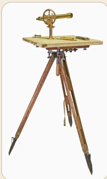
Мензульный комплект: тренога с мензулой (1-я пол. 20 в.), планшетом (1950-е гг.) и кипрегелем. Из «Открытой коллекции» музея истории и трудовой славы Заволжского моторного завода (ЗМЗ) · Источник
